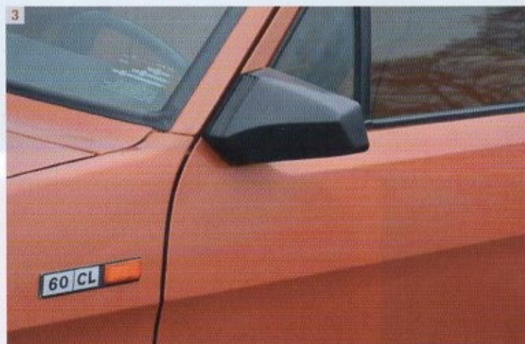
1: Getint glas, een optie, hield de vernietigende invloed van uv-licht op de originele bekleding niet tegen. 2: Grappig hoe de koplampen de motorkap en bumper lijken weg te duwen om naar buiten te kunnen kijken. 3: Fantastisch geïntegreerde buitenspiegel, die een fractie bijdraagt aan de luchtweerstandscoefficiënt van 0,38. 4: Een uitgesproken voorbeeld van hoe je vorm en functie perfect laat samensmelten. 5: Fiat, het merk van de felgekleurde distributiedeksels.
