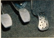
Durchlöcherete Metallplatte als Gaspedal
