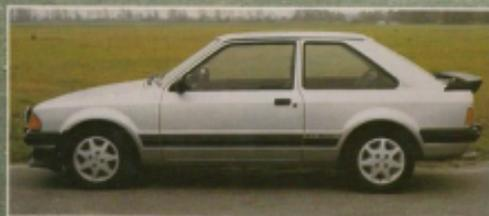
Der RS 1600i ist ein Auto, mit dem Ford in der Gruppe A Motorsport betreiben will. Der Einspritz-Motor verfügt über einen Leichtmetall-Zylinderkopf und Benzineinspritzung. 22 950 Mark
