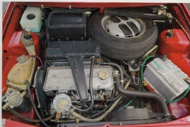
Der Golf Diesel hatte es ab 1978 vorgemacht: Selbstzünder waren auch in der Mittelklasse groß im Kommen. Das Aggregat im Ritmo holte aus 1,7 Liter 55, später 58 PS bei 4500 Touren. Ab 1985 kam eine vom neuen Turbodiesel abgeleitete Variante mit 60 PS zum Einsatz
