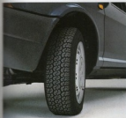
Spezielle 14-Zoll-Felgen, Breitreifen mit Niederquerschnitt-Profil 165/65 SR 14 - Ritmo 85 Super Automatik: 165/70 SR 13.
