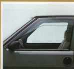
Strömungsgünstige Windabweiser an den vorderen Seitenscheiben.
