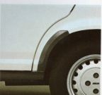
Hinter Radklappen mit schlagfestem Schutz gegen Steinschlag.
