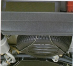
Platzsparende Unterbringung des Reservewades unter dem Kofferraum.
