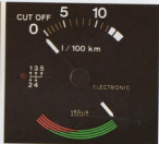
Elektronische Verbrauchs-Anzeige, die auch die Zen der Schubabschaltung sichtbar macht. Oben genaue Verbrauchswerte, unten Wirtschaftlichkeitsbereiche.
