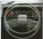
Stufenlose Höhenverstellung des Lenkrads.
