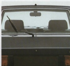
Heckscheibe heizbar und mit Wischer/Wascher-Anlage.
