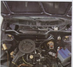
Hochwirksame Geräusch-Isolierung zwischen Motor und Innenraum.
