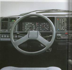
Informativ und funktionell die neu gestaltete Instrumententafel; zusätzlich jetzt mit Analog-Uhr, Wassertemperatur-, Kraftstoff-Anzeige und Reserveluchte; Kontroll-Leuchte u.a. für getriggerten Choke und Verschleiß der vorderen Bremsbeläge; Und: Verbrauchsanzeige.
