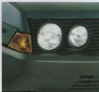
Doppelscheinwerfer in Hakogen-Ausführung.
