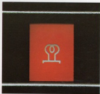
Kontroll-Leuchte für die Schnell-Vorwärmung durch Glühkerzen.
