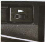
Helligkeits-Regler für die Instrumenten-Beleuchtung.
