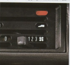
Dreistufiges Gebälge für Heizung und Belüftung.
