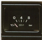
Exakte Angaben über die Motorschmierung durch Öldruckmesser.
