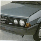
Stoßfänger aus Kunststoff mit neuer Wabenstruktur im Inneren.
