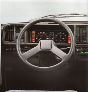
Das neue Armaturenbrett. Modernste und superfunktionelle Linie, gestylt aus den bewährtesten synthetischen Materialien (Polycarbonat und ABS). Sie besitzen die höchste Absorptionskapazität und sind gegen Kratzer und Verschleiß besonders widerstandsfähig.
