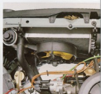
Der Kühler ist aus Aluminium: Eine raffinierte Lösung, die sich durch geringes Gewicht und schnellsten Wärmeaustausch auszeichnet.
