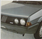
Neue Stoßstangen aus Kunststoff in einer neuen Zellenbauweise - eine absolut technische Novität.
