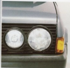
Neue Frontpartie mit Doppelscheinwerfer (zwei Innerscheinwerfer: Halogen).
