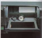
Beleuchtetes Handschuhfach mit Make-up-Spiegel und ausziehbarer Taucherlampe.
