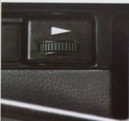
Helligkeitsregler für die Instrumentenbeleuchtung.
