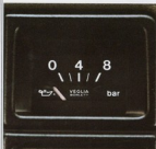
Exakte Angaben über die Motorschmierung durch Öldruckmesser.
