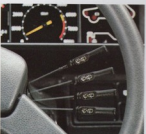
Hebel für die dreistufige Wasch-/wischenanlage mit Intervallschaltung.
