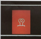
Kontroll-Leuchte für die Schnell-Vorwärmung durch Glühkerzen.
