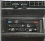
Hauptregler für die neue Frischluft- und Heizungsanlage mit ungewöhnlicher Leistung.
