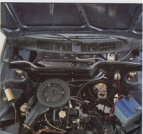
Lufthürde zwischen Motorraum und Fahrgastraum. Sie wirkt schalldämmend und sorgt für überdurchschnittliche Belüftung.
