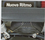
Das Reserverad ist in einem „Korb“ unter dem Kofferraum untergebracht und vom Kofferraum aus zu lösen.
