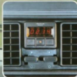
Von allen Plätzen gut sichtbarer Digital-Uhr mit integrierten Stopp-Funktionen.
