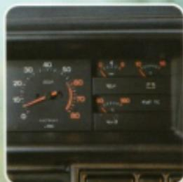
Leistung und Funktionssicherheit immer unter Kontrolle: Drehzahlen, Öldruck, Öltemperatur, Batteriespannung.
