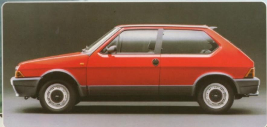
Solider Rundumschutz, der zugleich die Windschnitzigkeit verbessert, und die unverwundlichen Kunststoff-Stoßfänger und -Spolier. Elastische Seitenleisten und Kartoventstärkungen halten Steinschläge fern und widerstehen fremden Auswärtigen in engen Parklücken. Außerdem betonen sie die sportlich markante Linie der TC-Modelle.
