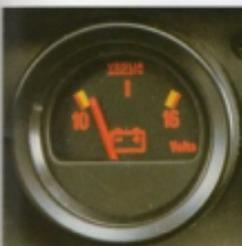
◀ Voltmeter zeigt exakt die Batteriespannung an.
