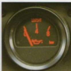
◀ Immer die Hand „am Puls des Kreislaufs“ hat der routinierte Fahrer durch den Blick auf den Öldruckmesser.
