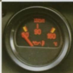
◀ Hier am Ölthermometer wird die Schmierfähigkeit des Motoröls deutlich sichtbar gemacht.
