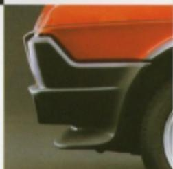
◀ Frontspoiler und beim Abarth auch Heckspoiler wirken dem Auftrieb des Luftstroms bei hohem Tempo entgegen. Mittelablage und Radio-Konsole sind für Fahrer und Beifahrer gleich gut erreichbar.
