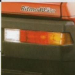
▶ Brems- und Blinklicht, Nebelleuchte und Rückfahrleuchte in der Stoßstange integriert.
