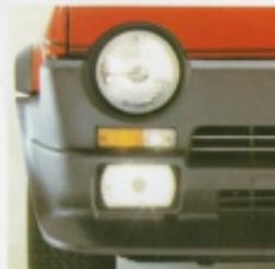
◀ Halogen-Haupt- und Zusatzscheinwerfer, letztere im Frontspoiler integriert, sorgen für taghelle Fahrbahn.
