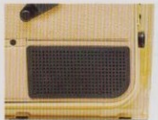
luidsprekerrooster in de voorportieren ingebouwd
