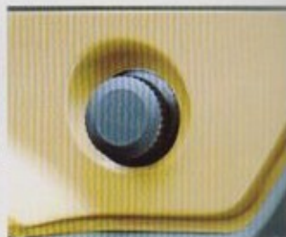
anti-diefstal rooster in hals van benzineleiding
