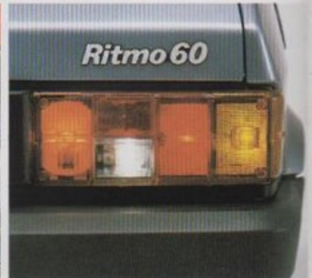
Grote, goed zichtbare achterlichtgroepen met aan weerszijden zowel een mistachterlicht als een achteruitrijlamp.
