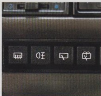
Drukknopschakelaars met geïntegreerde, verlichte functie-aanduiding.
