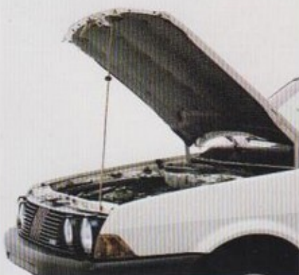
Motorruimte geheel bekleed met geluid-dempend materiaal.
