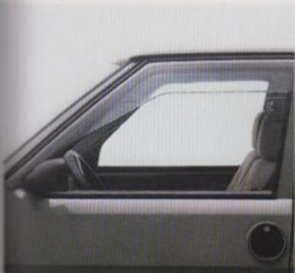
Speciale anti-luchtwervelingskappen op de ramen van de voorportieren.
